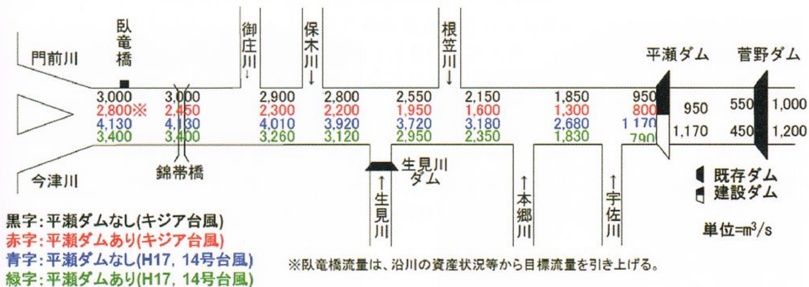
図 1.1-4 錦川水系河川整備計画における流量配分図(文献 8)より引用)
