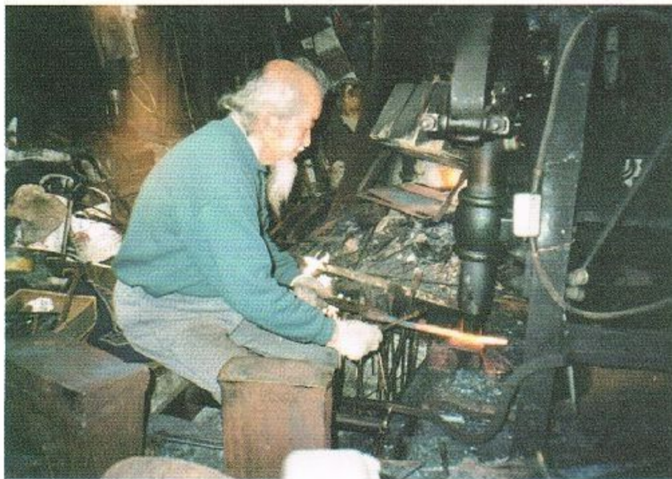
写真 6.5-5 和釘製作状況(岩国市撮影)
