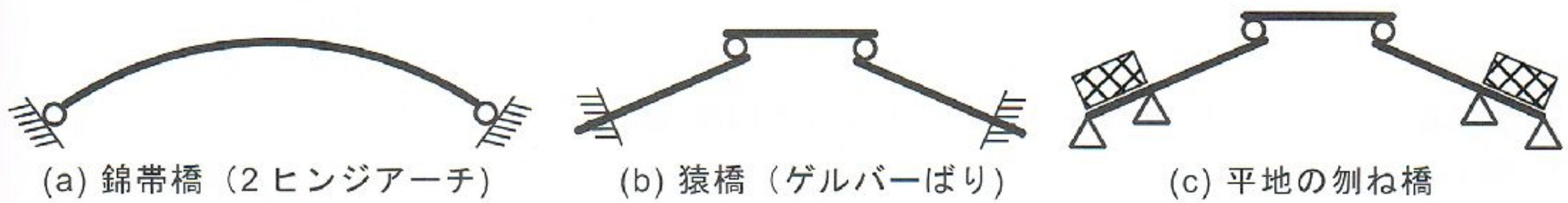
図 5.3-3 主構造の耐荷メカニズム(著者作成)
